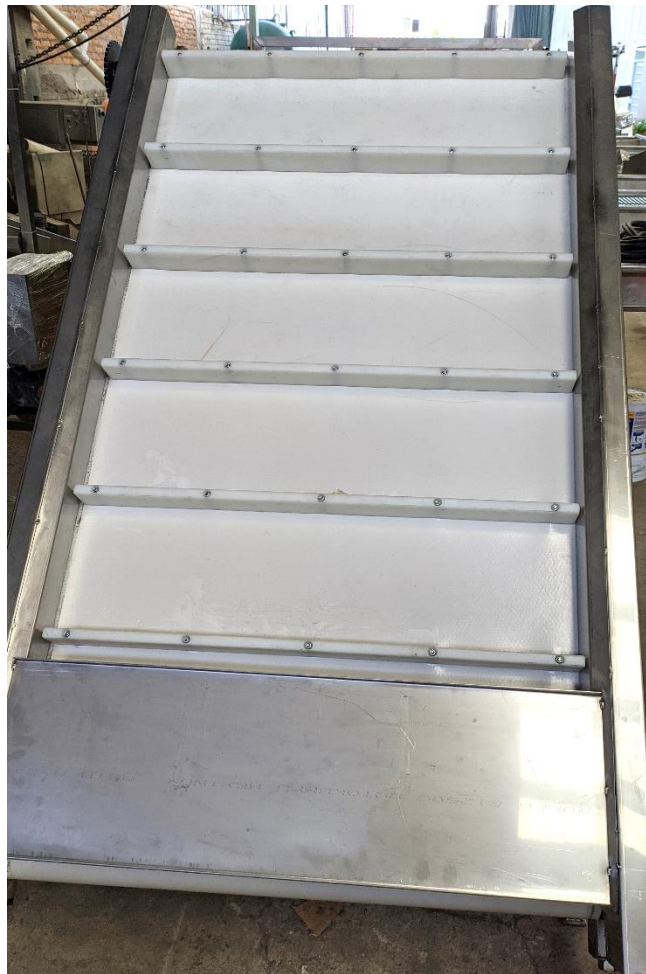
Figura 5. Sección de elevación de la máquina seleccionadora de ajo.
