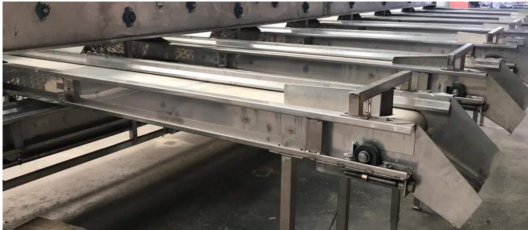
Figura 7. Sección de bandas transportadoras de la máquina seleccionadora de ajo.
