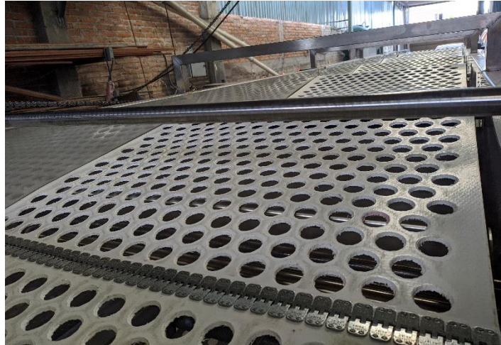
Figura 6. Sección de seleccionado o de cribas de la máquina seleccionadora de ajo.
